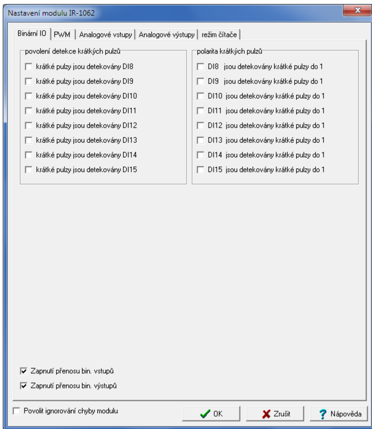
Obr.4.8 Konfigurace binárních vstupů a výstupů
