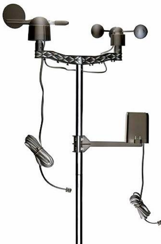
Obr. 11.6.1.1 Sestava anemometru T114, ukazatele směru větru T115 a srážkoměru T116
