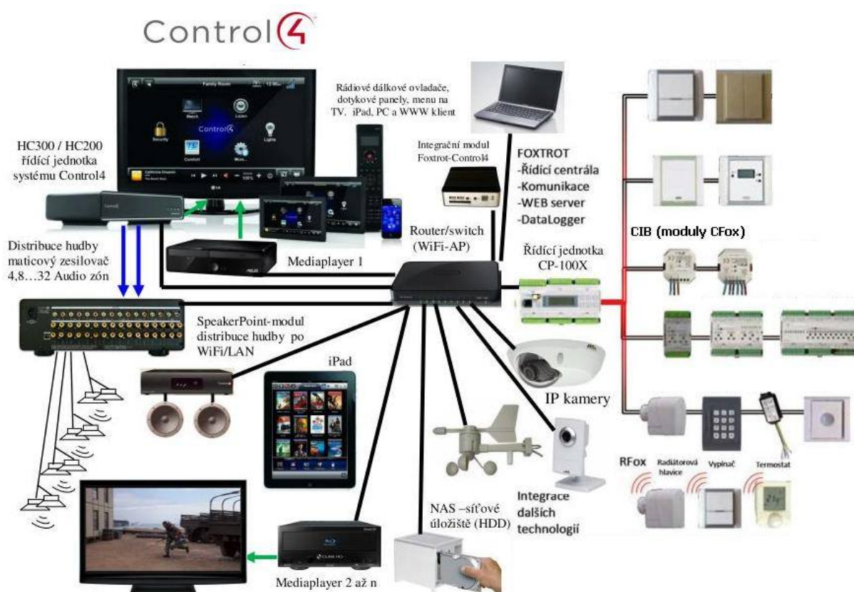
Obr. 9.4.1.1 Ilustrační příklad propojení systémů Control4 a Foxtrot
