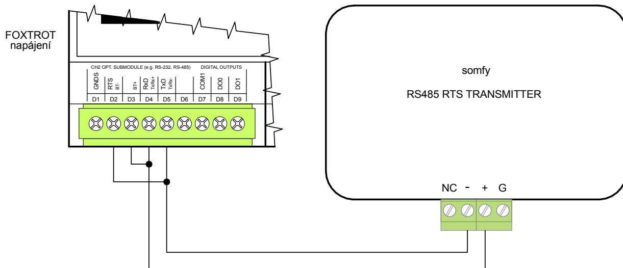
Obr. 7.1.5.1 Příklad zapojení žaluzií SOMFY rozhraním RS-485
