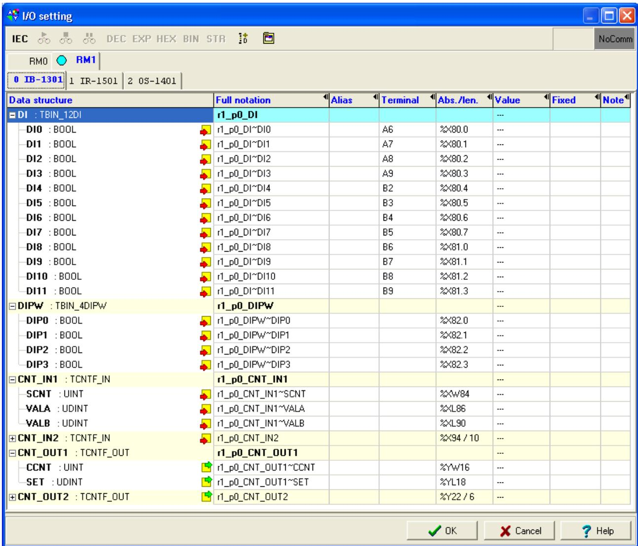
Fig.3.1.5 IB-1301 module data structure
