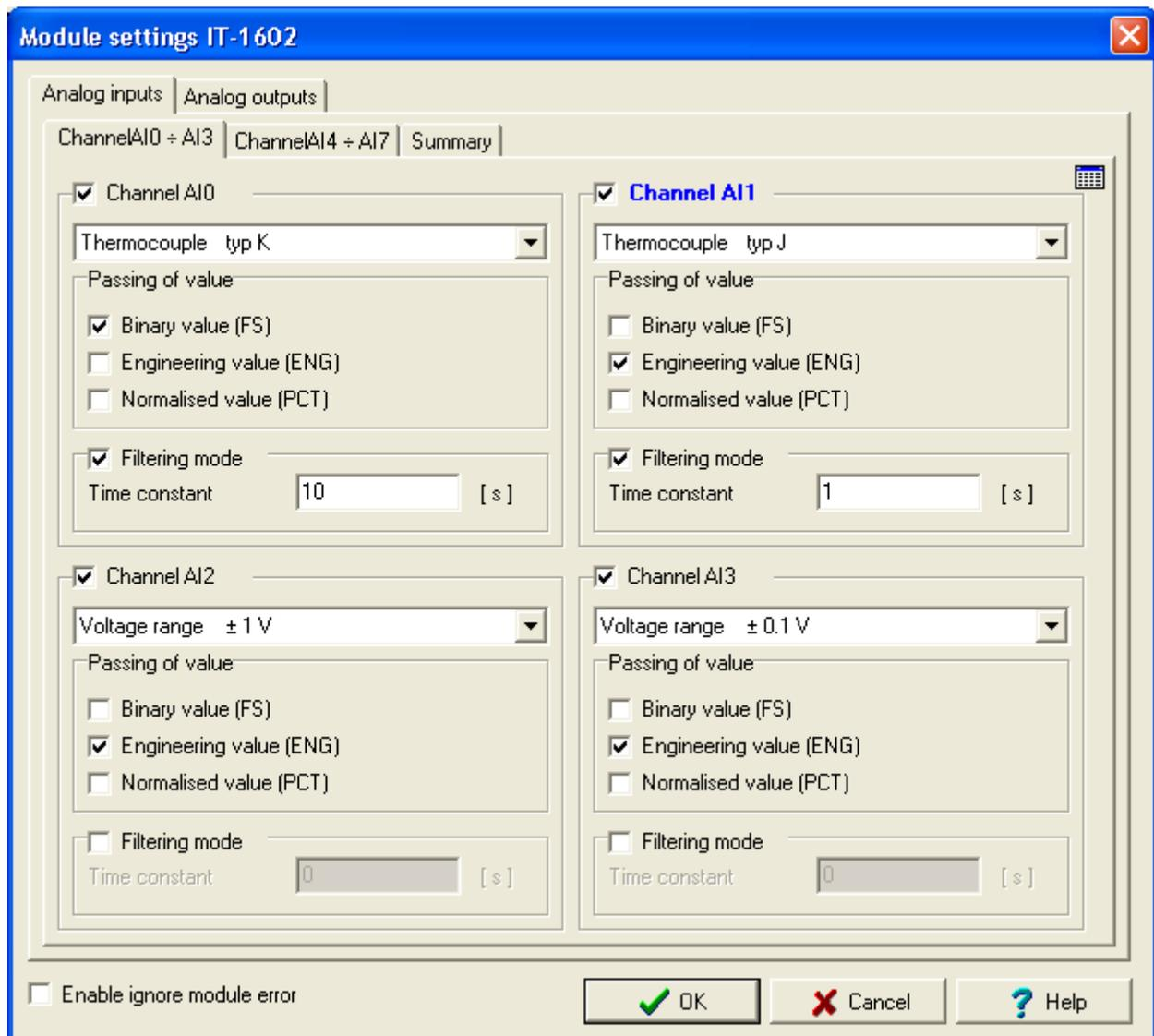
Fig.3.4.19 Analog inputs configuration
