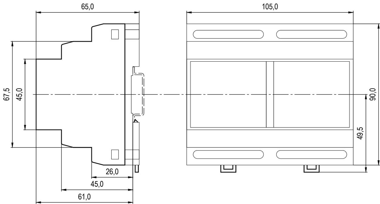
Fig..1.4 Basic module dimensions
