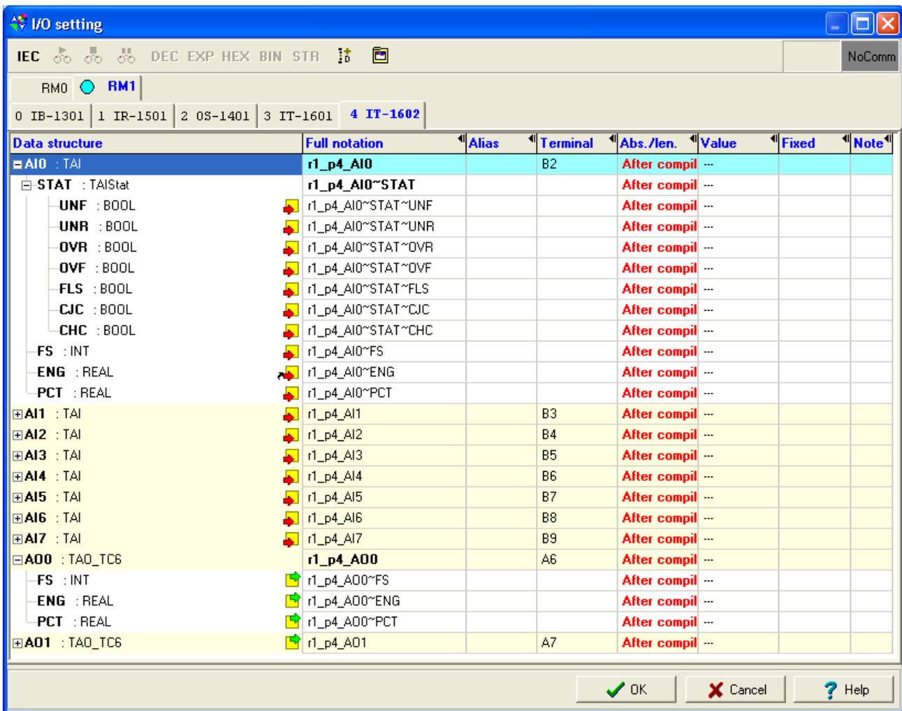
Fig.3.4.17 IT-1602 module data structure
