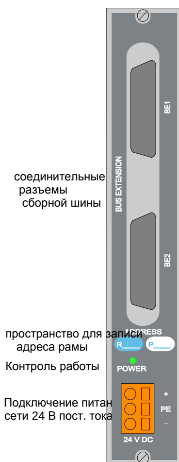
Рис.2.5 Передняя панель модуля питания PW-7906
