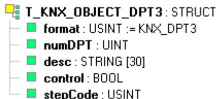
Datový typ *T\_KNX\_OBJECT\_DPT3* je struktura, které obsahuje informace o stavu KNX objektu typu DPT3 (4 Bit, Control Dimming, Control Blinds). KNX objekty se v modulu KNX IP BAOS 772 označují jako **datapoint**.
