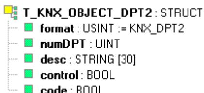
Datový typ *T\_KNX\_OBJECT\_DPT2* je struktura, které obsahuje informace o stavu KNX objektu typu DPT2 (2 Bit Control). KNX objekty se v modulu KNX IP BAOS 772 označují jako **datapoint**.
